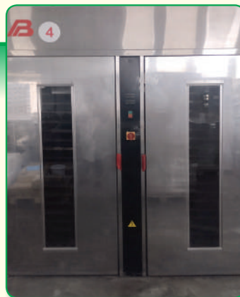
Шкаф расстойный «бриз-342»
